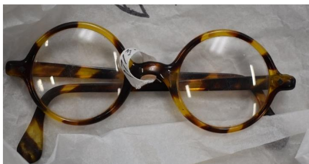
Fig. 34. På brillestangens afslutning ses korroderende salte i overfladen, et typisk nedbrydningsfænomen for celluloid (deltaljefoto th.; se også Fig. 19). Saltens koncentration i dette område kan skyldes at brillen her har været udsat for hudens sved. VejleMuseerne.
