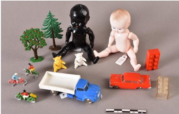
Fig. 27. Sprøjtstøbt legetøj af celluloseacetat produceret af LEGO Koncernen 1950 -60erne. LEGO Group Archives.
