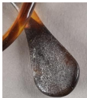
Fig. 34. På brillestangens afslutning ses korroderende salte i overfladen, et typisk nedbrydningsfænomen for celluloid (deltaljefoto th.; se også Fig. 19). Saltens koncentration i dette område kan skyldes at brillen her har været udsat for hudens sved. VejleMuseerne.
