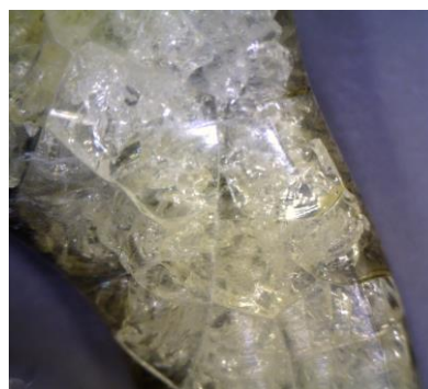
Fig. 33. Celluloidbrille fra Mark/ Billund Kommunes Museer der viser forskellige nedbrydnings tegn: Den for nedbrudt celluloid typiske krakelering (mikroskopoptagelse øverst th) og udsvedning af dråber på overfladen (mikroskopoptagelse nederst).
