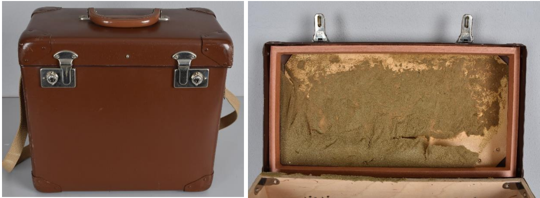
Fig. 17. Transporttaske fra Mark | Museet for en Ny Danmarkshistorie. Tasken er indvendigt foret med PUR-ester skum, som nu er fuldstændig nedbrudt, smuldret og ikke til at redde. Mark | Billund Kommunes Museer.
