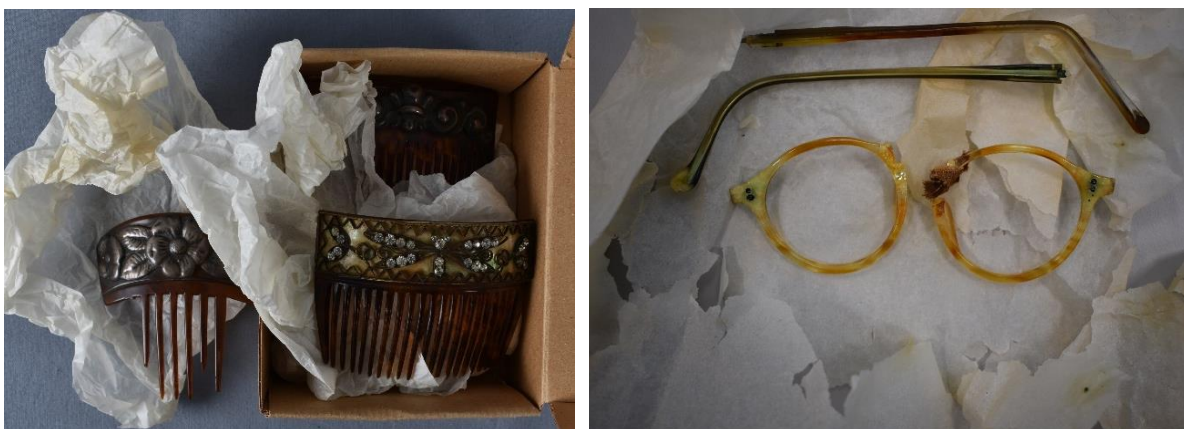
Fig. 21. Papir som indikator. Foto tv.: Celluloidkamme har misfarvet papiret i en gullig tone, hvilket er et tydeligt tegn på startende nedbrydning. Foto th.: Papiret, celluloidbrillerne har været pakket ind i, er ikke kun misfarvet men også desintegreret (sammenlign Fig. 11).
