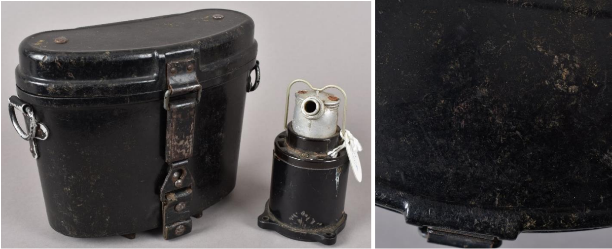
Fig. 35. Tysk kikkerthylster af PF og måleinstrument med fod af PF. Materiale domineret af celluloseholdigt fyldstof nok træmel eller lignende, ofte brugt som fyldstof i PF. Mark | Billund Kommunes Museer.
