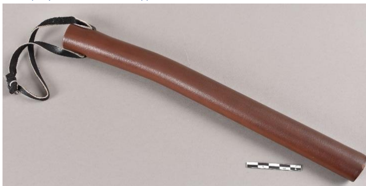
Fig. 40. Gummiknippel fra 1940erne af BUNA-S med kaolin som fyldstof. Mark | Billund Kommunes Museer.
