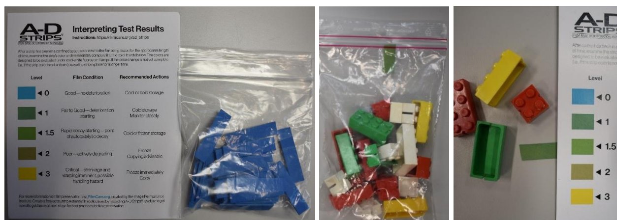
Fig. 18. Foto tv.: Blå AD-strips som de fås fra forhandleren med en vejledning til brug for test af CA-genstande. Foto midt og th.: LEGO klodser af CA i lukket pose testes med AD-strip. Der ses et tydeligt skift til lysegrøn efter et døgn. Tydelig lugt af eddikesyre ved åbning af posen. Materialet har nået et punkt, hvor nedbrydning accelererer. LEGO klodser fra Mark | Billund Kommunes Museer.
