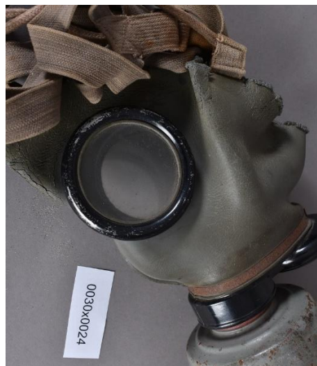
Fig.38. Gasmaske af gummi. gummien er stiv og masken deformeret. Gummien smuldrer langs kanter. Der ses sprækker og revner langs folder og knæk. Masken bør rettes ud i form, og formen understøttes. Mark | Billund Kommunes Museer.
