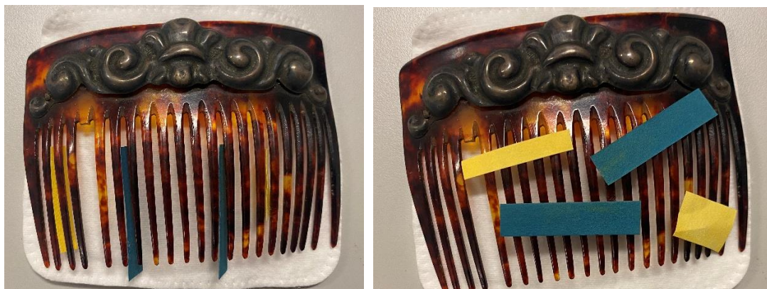
Fig. 22. Sammenligning af kresolrød indikatorer (gule) og AD-strips (blå). Indikatorerne er placeret mellem tænderne på en kam af celluloid (foto tv.). Efter et par døgn ses, at tænderne har givet en svag, gullig streg på AD-stripsne, hvilket er et tydeligt tegn på syre. I modsætning hertil ses ikke farvning af kresolrød-indikatorerne. Dette viser at AD-stripsne viser større følsomhed overfor syre end kresolrøddindikatorerne, og må siges at være mere pålidelige.
