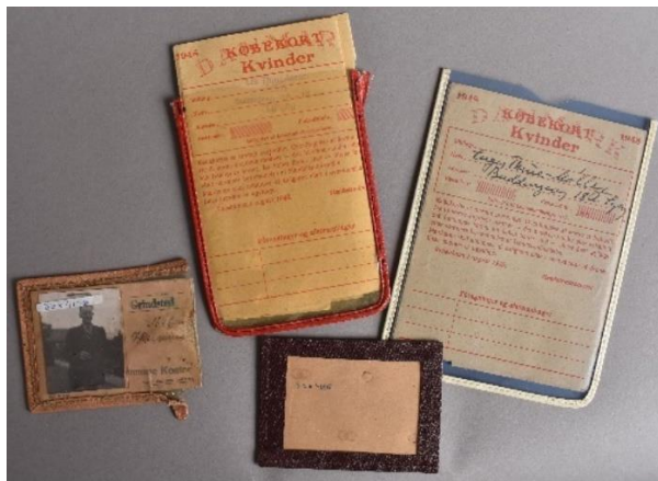
Fig. 32. Diverse etuier med plastfolier, som enten består af CN (de to længst til venstre) eller CA (de to længst til højre).
