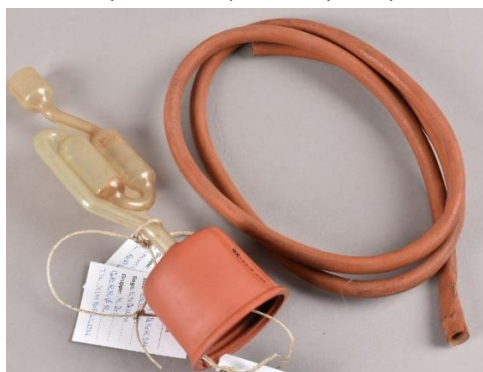
Fig. 39. Gærrør med korkprop og gummi: FTIR-analyse peger på at gummidelen er en blanding af BUNA-S og naturlig gummi. Slange: Buna-S.
